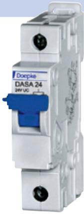
Arbeitsstromauslöser zur Fernauslösung von Leitungsschutzschaltern der Baureihe DLS 6 bzw. MCB. Der Arbeitsstromauslöser wird durch einen Arbeitsstrom einer externen Spannungsquelle aktiviert. Die Auslösung erfolgt dabei durch eine mechanische Entklinkung des angekoppelten Leitungsschutzschalters. Der Arbeitsstromauslöser beeinflusst den Leitungsschutzschalter nicht in seiner Schutzfunktion.
