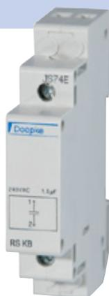
Taster mit integrierten Leuchtmitteln können beim Betrieb an den Stromstoßschaltern der RS-Serie durch ihre Induktivität zu ungewollten Schaltaktivitäten führen. So lassen sich ohne weitere Hilfsmittel durchschnittlich bis zu acht solcher Taster an einem RS bzw. einem RSZ betreiben. Für den Anschluss weiterer Leuchttaster ist die Kompensation mit einem Kondensatorblock RS-KB notwendig, der die maximale Anzahl auf 23 Leuchttaster erhöht.
