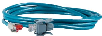
Die Anschlussleitung DTCC verbindet das allstromsensitive Differenzstrom-Überwachungsgerät DRCM 1 B+ bzw. das allstromsensitive Fehlerstrom-Steuerrelais DMRCD 1 B+ mit dem Wandler der Baureihe DCT B+. Der spezielle RJ45-Stecker ist rüttelfest und sorgt somit für eine sichere Verbindung zwischen Auswerteeinheit und Wandler, auch bei widrigen Umgebungen.
