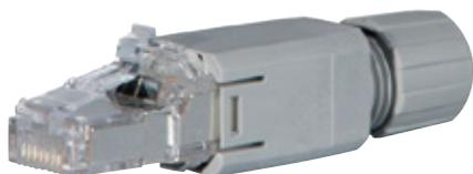
Dieser Anschlussstecker ermöglicht die Eigenfertigung von Leitungen für die Verbindung der Differenzstromwandler DCT B+ mit einem Steuerrelais DMRCD 1 B+ bzw. einem Melderelais DRCM 1 B+. Der DTCC-RJ45 ist ein industrietauglicher achtpoliger RJ45-Steckverbinder mit einer Schnellanschlusstechnik, die starre und flexible Adern von AWG 26-22 aufnehmen kann. Es wird kein Spezialwerkzeug benötigt. Als Verbindungsleitung eignet sich Kabel nach CAT5e-Spezifikation.
