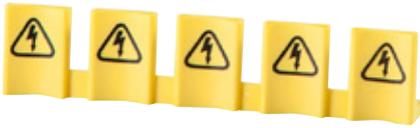
Die EV-S-BS-Berührungsschutzkappe ermöglicht das Abdecken freier Anschlüsse bei Sammel- bzw. Phasenschienen mit Gabelschuhen. Die auffällige gelbe Materialfarbe warnt vor gefährlichen Berührungsspannungen.
