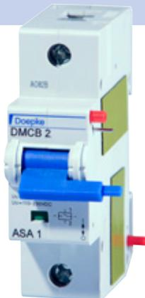
Arbeitsstromauslöser zur Fernauslösung von Leitungsschutzschaltern der Baureihe DMCB 2. Der Arbeitsstromauslöser wird durch einen Arbeitsstrom einer externen Spannungsquelle aktiviert. Die Auslösung erfolgt dabei durch eine mechanische Entklinkung des angekoppelten Leitungsschutzschalters. Der Arbeitsstromauslöser beeinflusst den Leitungsschutzschalter nicht in seiner Schutzfunktion.
