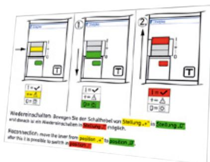
Der Schaltstellungsaufkleber beschreibt das Wiedereinschalten eines DFS 2 oder DFS 4 nach einer Auslösung, z. B. durch Betätigen der Prüftaste oder aufgrund eines anlagebedingten Fehlers. Die nötigen Schritte werden grafisch und im Text dargestellt.
